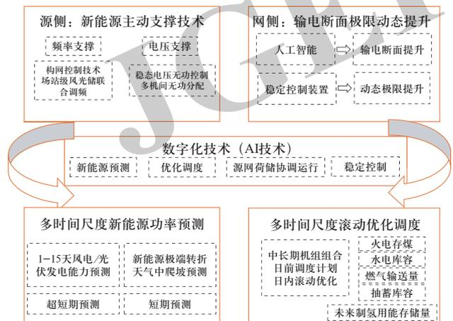
图7 特大型新能源基地运行场景关键支撑技术
