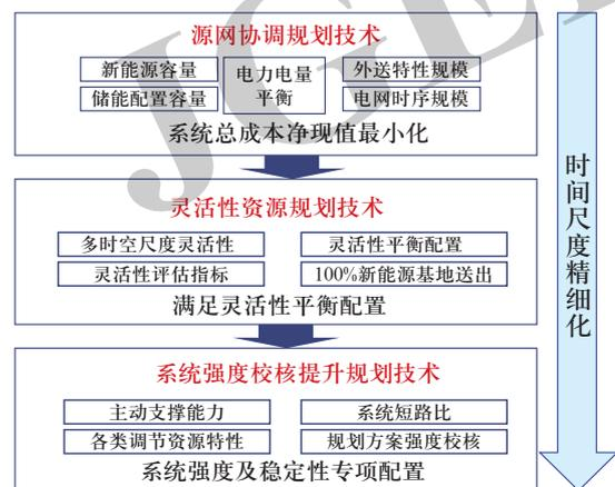
图 5 特大型新能源基地系统规划关键支撑技术
